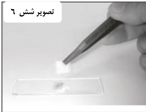
قرار دادن لامل (شیشه کوچک) روی نمونه
