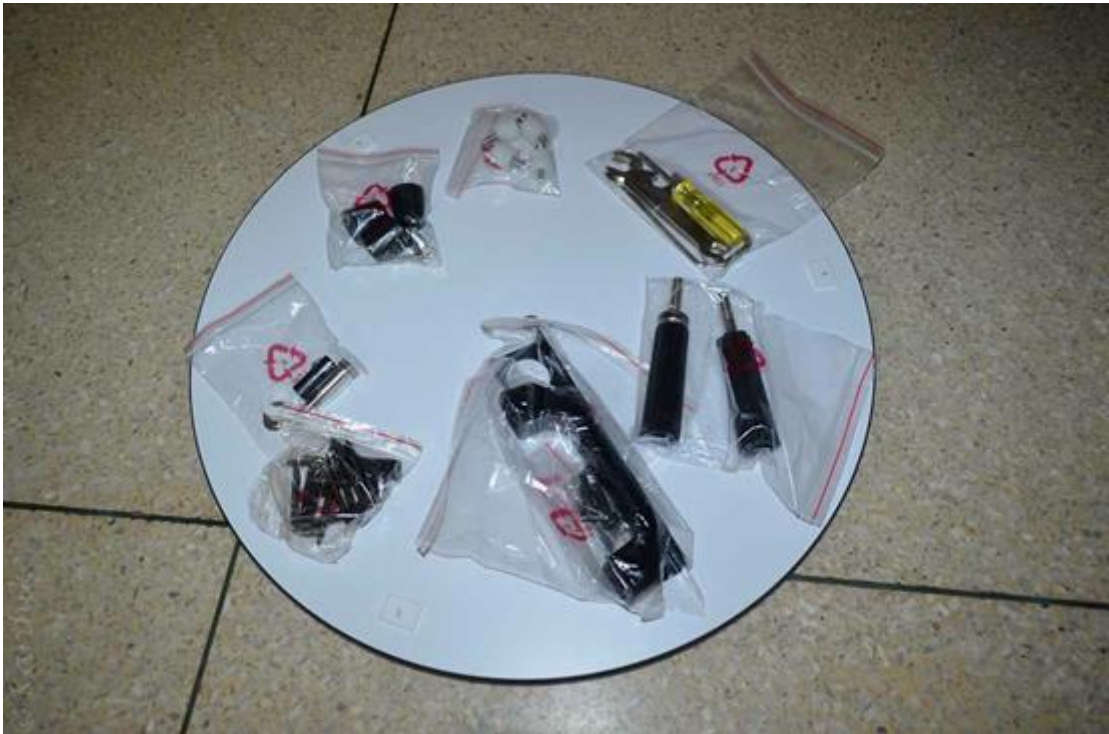
این‌ها لوازم و پیچ‌های استاندارد مخصوص نصب تلسکوپ هستند. به سه قطعه تفلنی که بعنوان بلبرینگ عمل می‌کنند توجه کنید.
