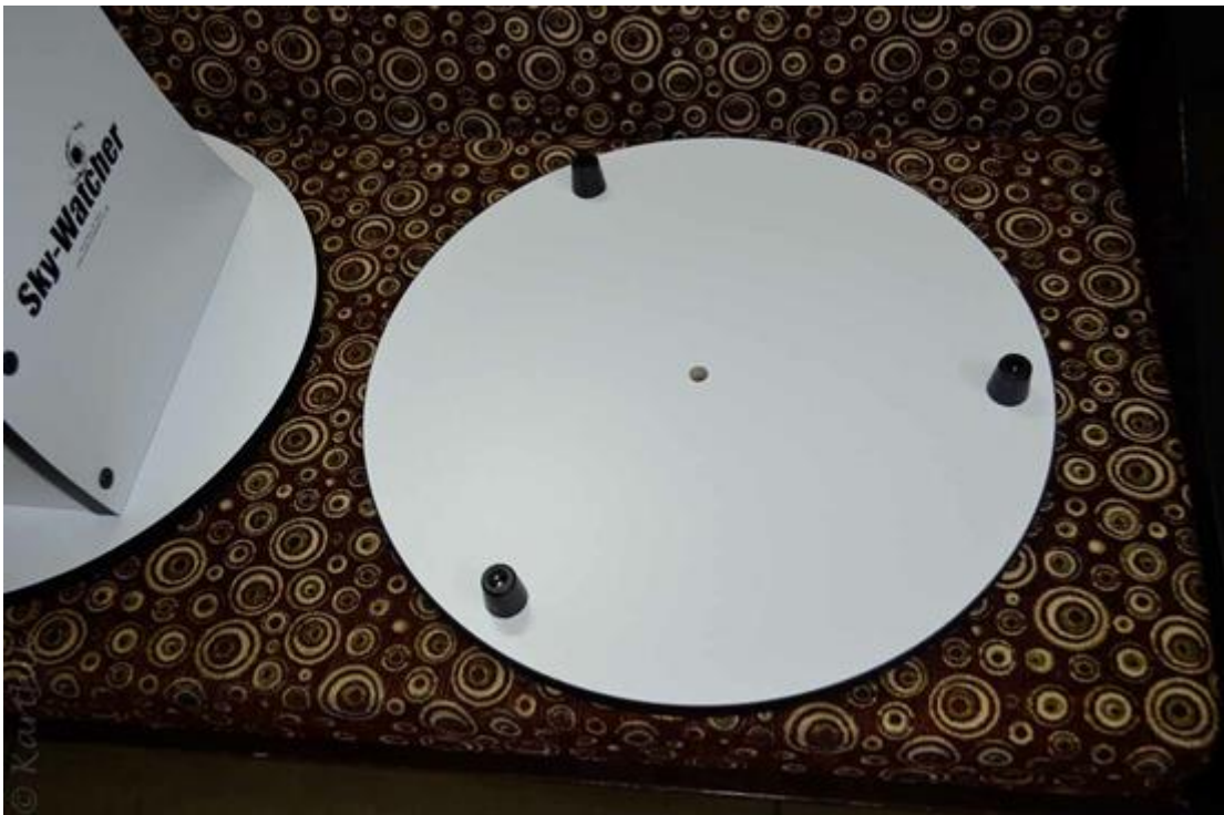
سپس ۳ قطعه نگهدارنده را به دیسک پایینی چفت کردم.
