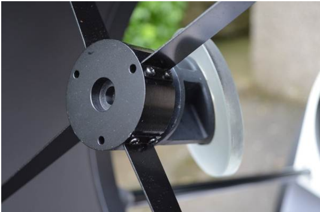
آینه ثانویه و عنکبوتی با پره‌های نازک
